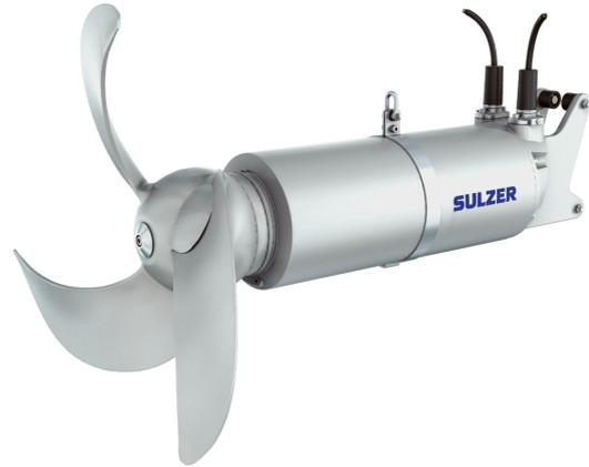
**Beschreibung:** Die Baureihe XRW 900 ist zur Installation am Führungsrohr konzipiert und bildet mit dem Edelstahlpropeller und der angegossenen Halterung eine kompakte, druckwasserdichte Einheit. Das Rührwerk ist in Graugussausführung (EC) oder in Edelstahlausführung (CR) erhältlich. Maximale Mediumtemperatur bei Dauerbetrieb = 40 °C.
